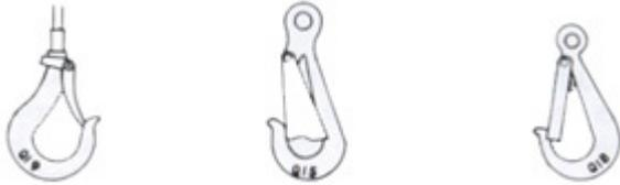
Attrezzatura utilizzata per l'imbragatura dei carichi, che deve essere effettuata usando mezzi idonei per evitare la caduta del carico o il suo spostamento dalla primitiva posizione di ammassaggio.
