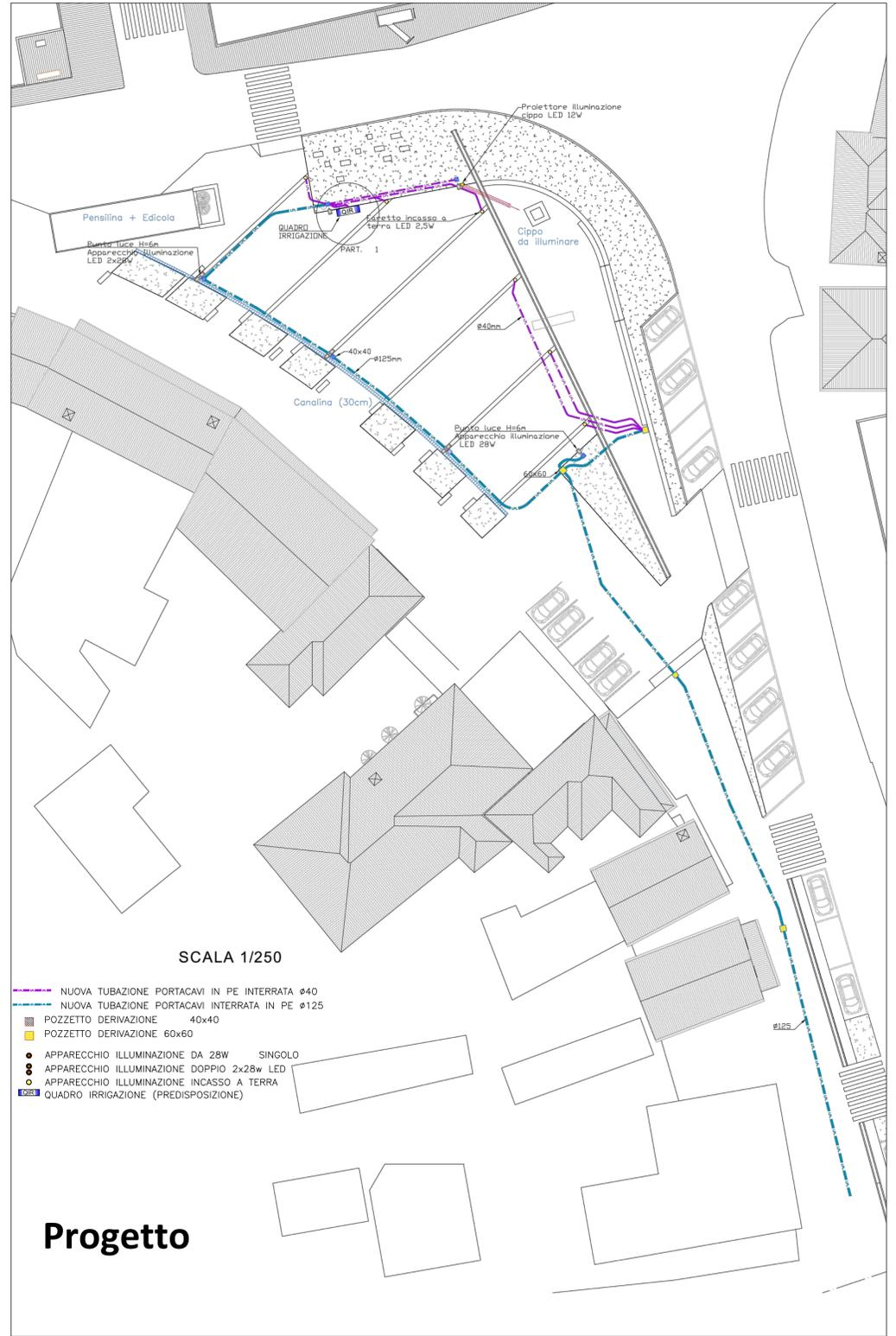
Panca per alloggiamento elettrovalvole e centraline di irrigazione; Elementi impianto elettrico di illuminazione
