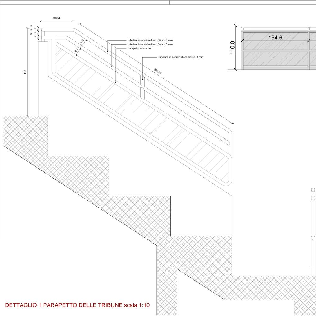
DETTAGLIO 1 PARAPETTO DELLE TRIBUNE scala 1:10
