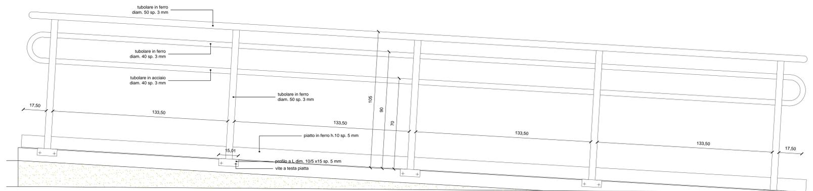
DETTAGLIO 5 PARAPETTO DELLA RAMPA DISABILI DELLA SCUOLA scala 1:10
