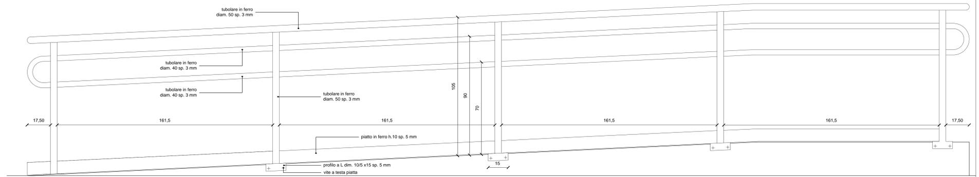
DETTAGLIO 4 PARAPETTO DELLA RAMPA DISABILI DELLA PALESTRA LATO EST scala 1:10
