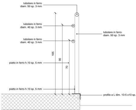
DETTAGLIO 3 SEZIONE TIPO PARAPETTO RAMPE DISABILI scala 1:10
