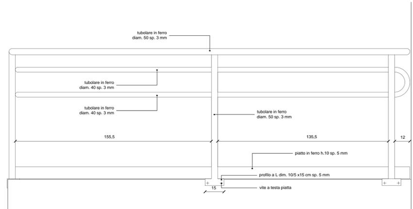
DETTAGLIO 4 PARAPETTO DELLA RAMPA DISABILI DELLA PALESTRA LATO NORD scala 1:10
